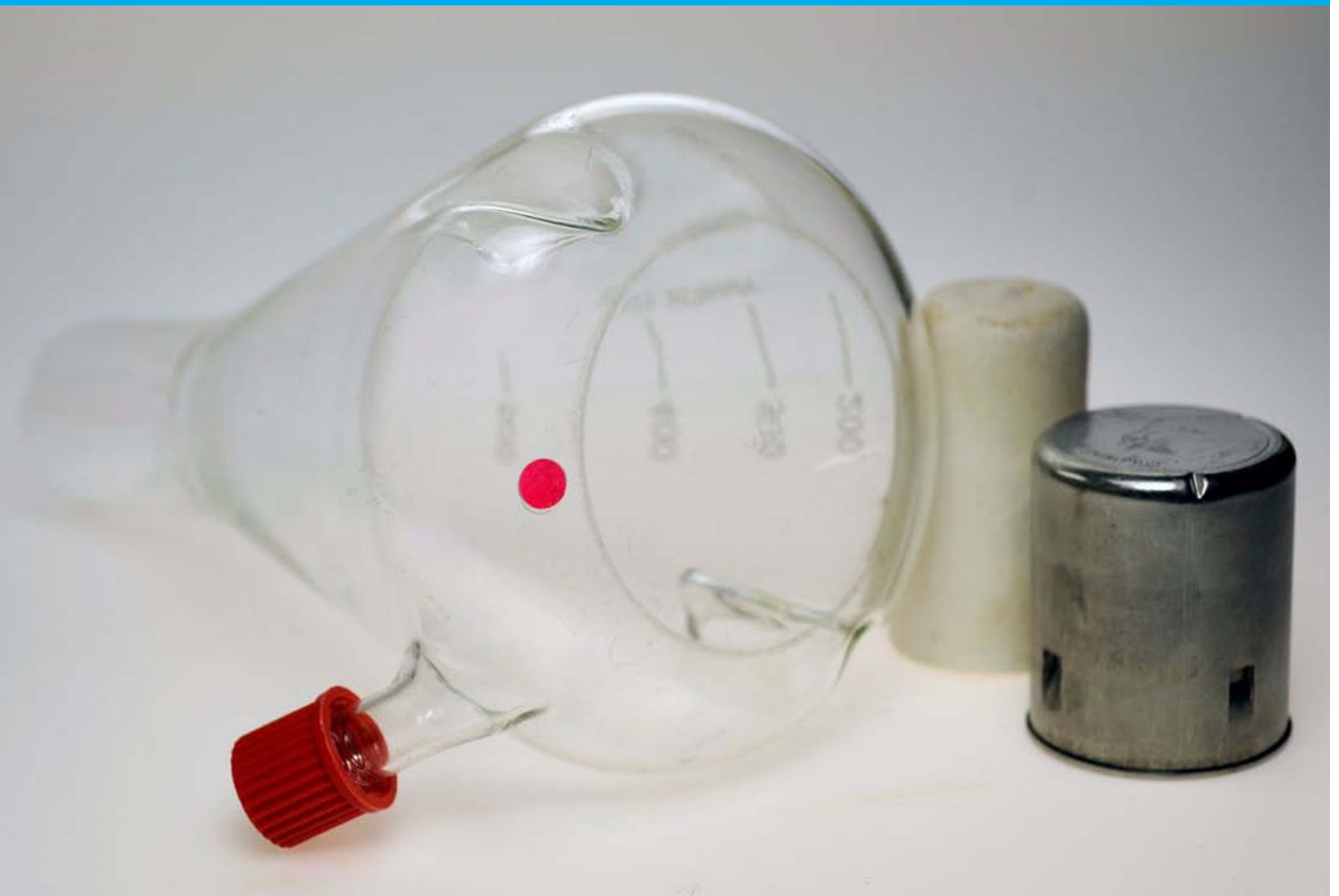
Bild 1: Schüttelkolben mit Schikanen und einem Septum; die integrierten Sauerstoffsensoren von PreSens wurden zur Ermittlung des Sauerstoffverbrauchs verwendet. PreSens ermöglicht die Integration der Sensoren in die Labor-eigenen Schüttelkolben, so dass Messungenauigkeiten durch den Wechsel an Methode und Material weitestgehend ausgeschlossen werden und eine große Vergleichbarkeit zu anderen Ergebnissen ermöglicht wird.
